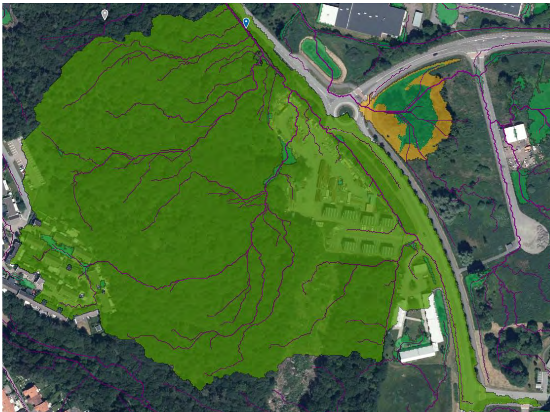
Figur 12. Flödesvägar enligt Scalgo, väster om Råvebergsvågen, Delområde A
