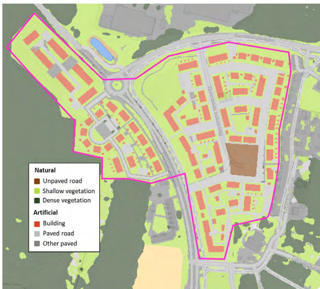
Figur 62. Markanvändning i Scalgo, framtid med skissförslag inom detaljplan.
