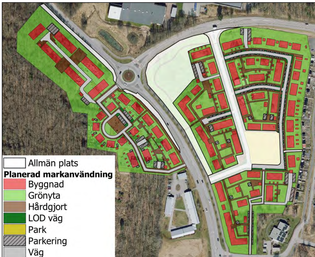
Figur 5. Planerad markanvändning inom detaljplanen samt förutsatt planläggning av ytor som allmän plats.
