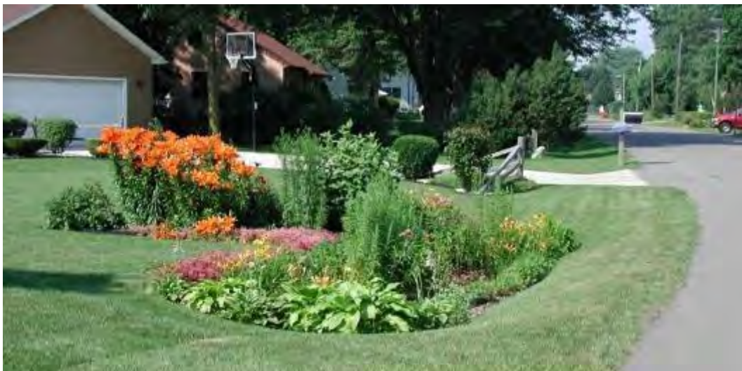
Figur 35. Lokal dagvattenhantering med växter i lågpunkt (Foto: Denbow)
